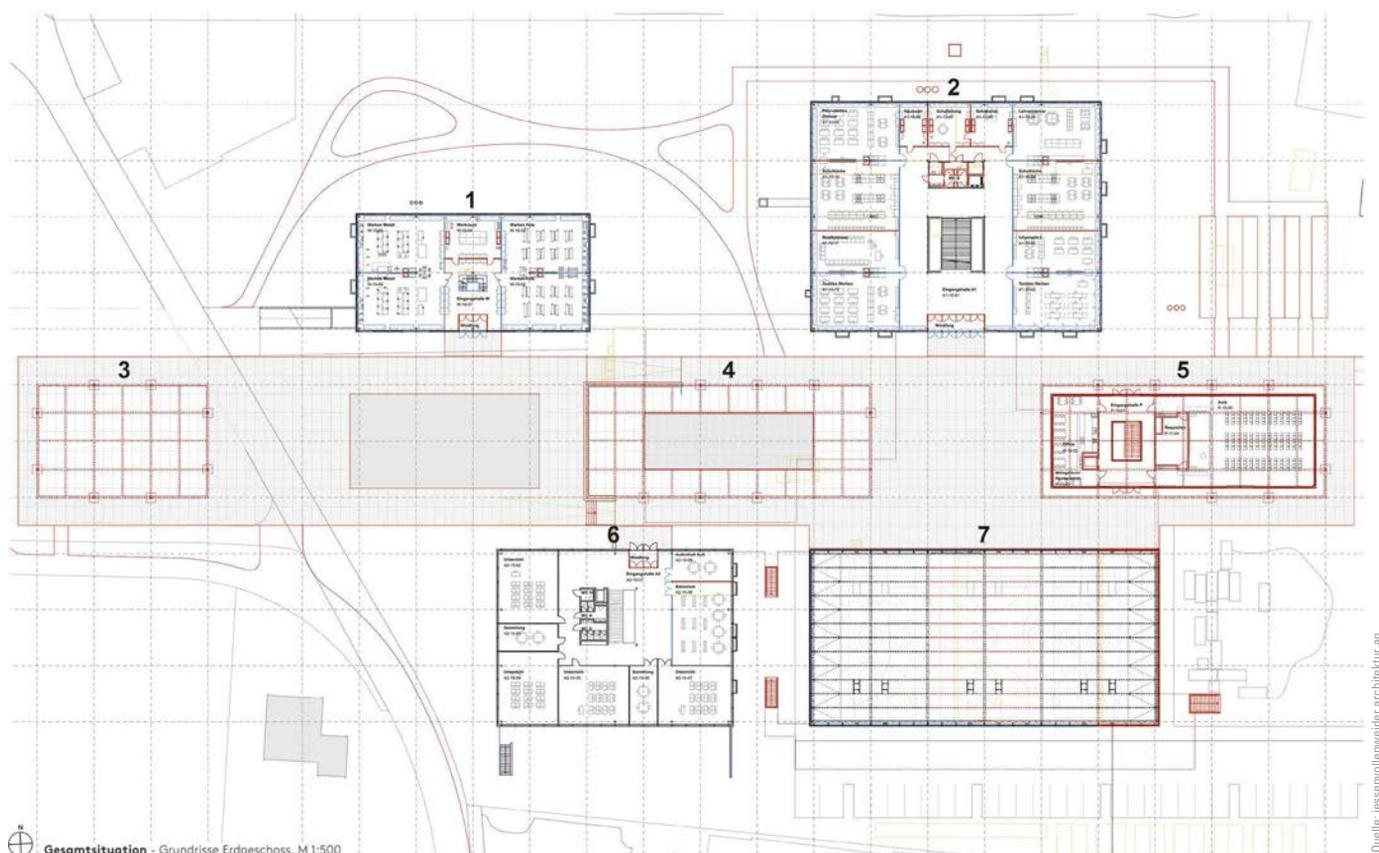
**Bild 2** Grundrisse Erdgeschoss: 1 Werkstatt, 2 Auen 1, 3 Velodach, 4 Pausendach, 5 Pavillon, 6 Auen 2, 7 Sporthalle
